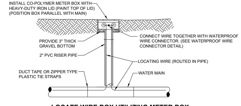
LOCATE WIRE BOX UTILIZING METER BOX
