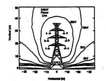
Figure 2. Equipotential Contours Surrounding Power Lines.
