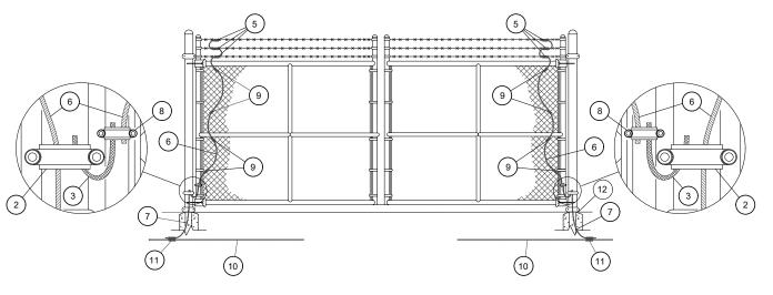
FENCE GROUNDING DETAIL - DOUBLE GATE
