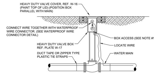
**LOCATE WIRE BOX UTILIZING VALVE BOX**
